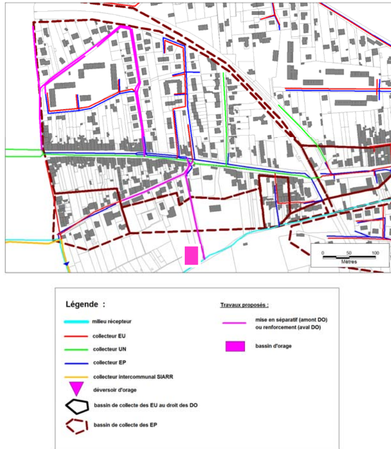
Figure 3-3 : Localisation des travaux relatifs au collecteur Champ d'Ojardias
